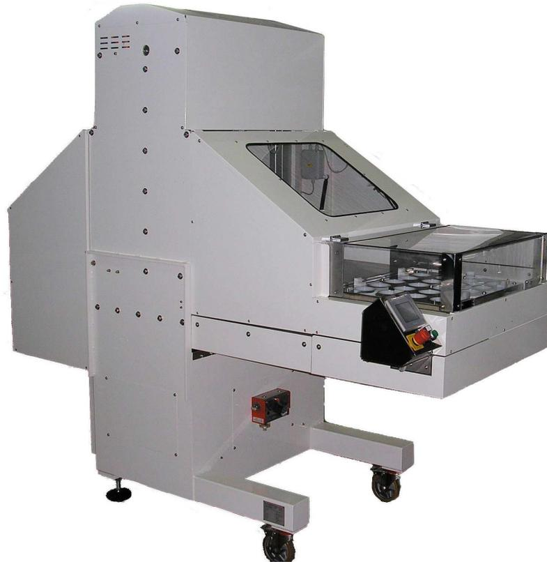
Macchina per la produzione industriale di coni di pasta di pizza tradizionale lievitata naturalmente. Stampa e pre-cuoce a ciclo continuo 20 palline di pasta lievitata per volta, senza alterarne il naturale processo di lievitazione grazie al sistema micrometrico computerizzato di riposizionamento continuo degli stampi. Le funzioni di carico pasta e scarico dei coni sono totalmente automatizzate ed integrate nella macchina stessa.
